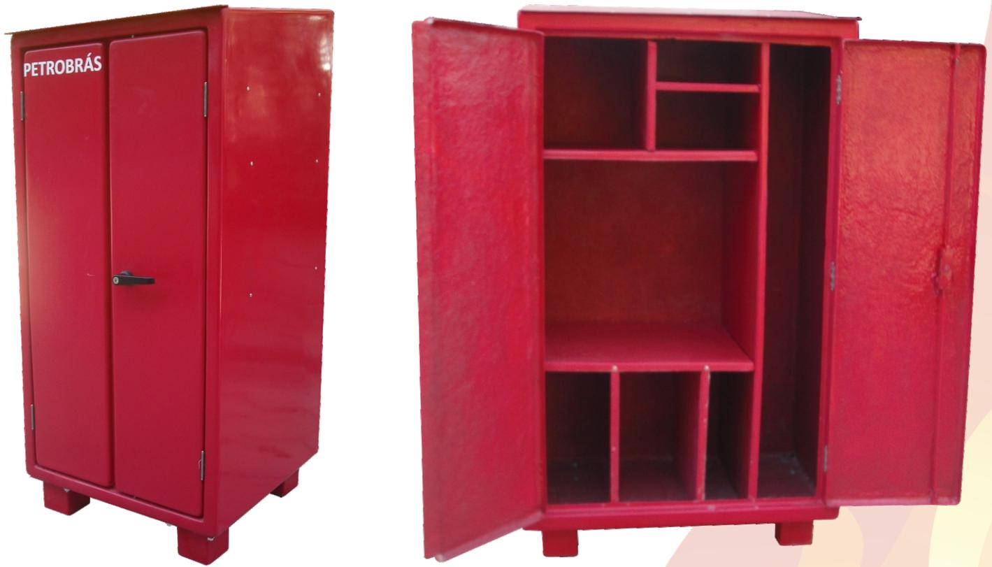
Armários para uso geral / equipamentos, código 1696, confeccionados em PRFV (Plástico Reforçado com Fibras de Vidro). Dispensam pintura, pois são pigmentados durante a fabricação com gel coat com aditivo contra raios Uv's.
