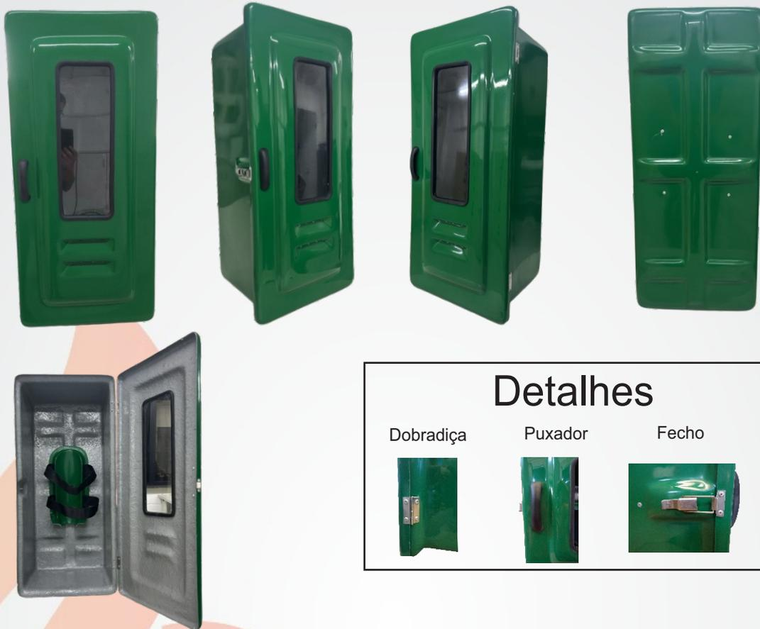
Armários para equipamento autônomo de respiração, código 833R, confeccionados em PRFV (Plástico Reforçado com Fibras de Vidro). Dispensam pintura, pois são pigmentados durante a fabricação com gel coat com aditivo contra raios UV's. São ideais para ambientes corrosivos e/ou com ação das intempéries. A porta é sobreposta à caixa, prevenindo infiltrações de água, dispensando pingadeiras.
