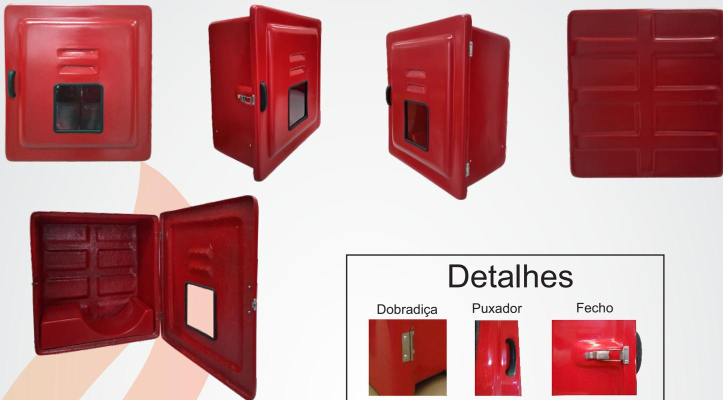
Abrigos para mangueiras, código 663, confeccionados em PRFV (Plástico Reforçado com Fibras de Vidro). Dispensam pintura, pois são pigmentados durante a fabricação com gel coat aditivado contra raios UV's.
