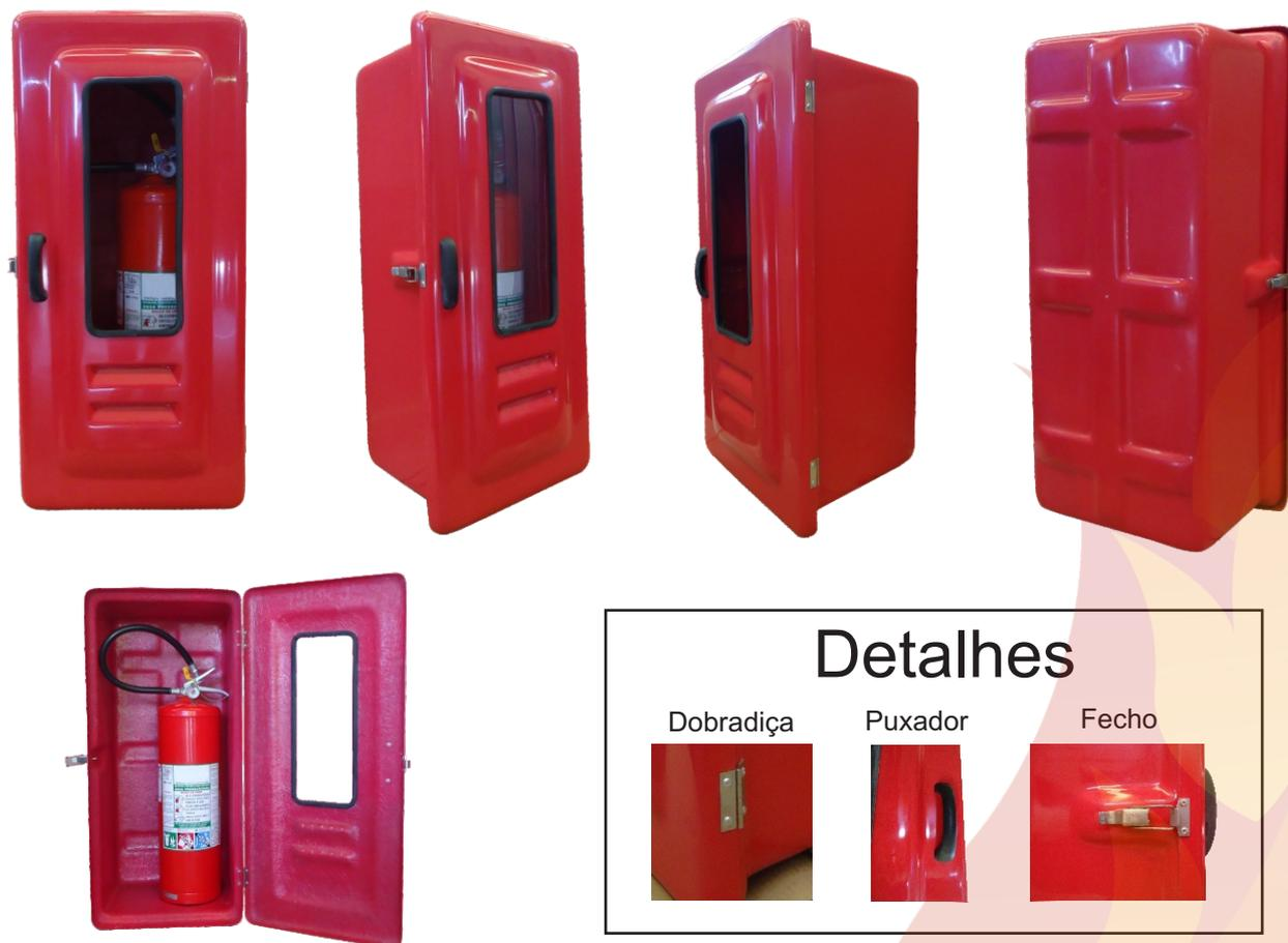
Abrigos para extintor, código 832, confeccionados em PRFV (Plástico Reforçado com Fibras de Vidro). Dispensam pintura, pois são pigmentados durante a fabricação com gel coat com aditivo contra raios Uv's.
