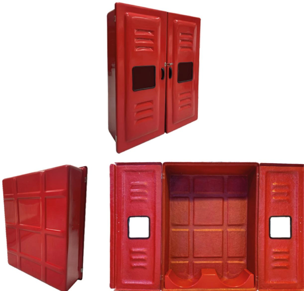
Abrigos para mangueiras, código 1293 confeccionados em PRFV (Plástico Reforçado com Fibras de Vidro). Dispensam pintura, pois são pigmentados durante a fabricação com gel coat com aditivo contra raios UV's. São ideais para ambientes corrosivos e/ou com ação das intempéries. A porta é sobreposta à caixa, prevenindo infiltrações de água, dispensando pingadeiras.
