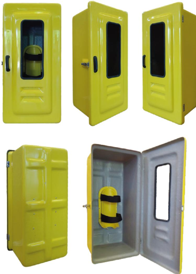
Armários para equipamento autônomo de respiração, código 833R, confeccionados em PRFV (Plástico Reforçado com Fibras de Vidro). Dispensam pintura, pois são pigmentados durante a fabricação com gel coat com aditivo contra raios UV's. São ideais para ambientes corrosivos e/ou com ação das intempéries.
