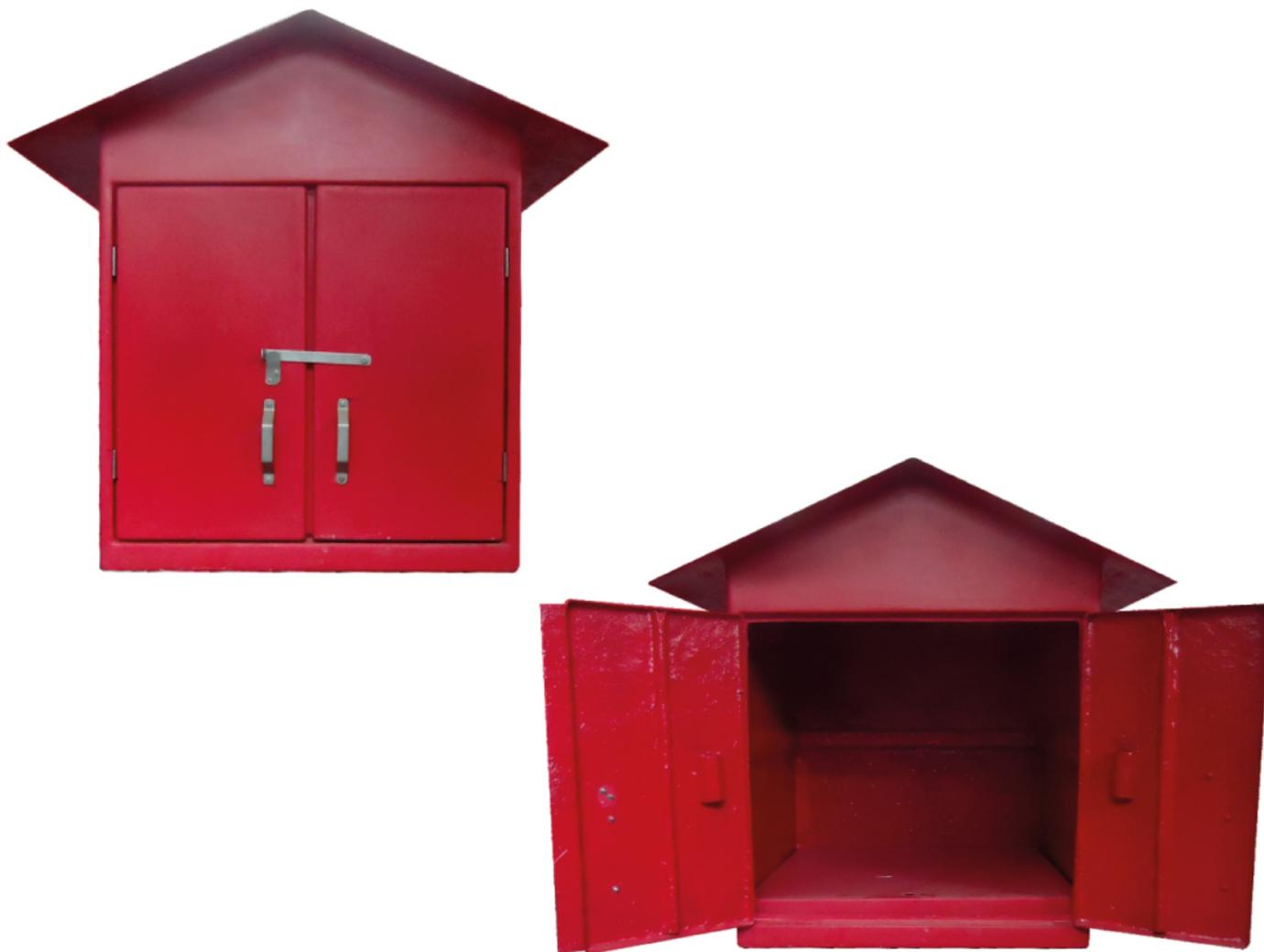
Abrigos destinados a abrigar mangueiras e acessórios para hidrantes. São confeccionados em PRFV (plástico reforçado com fibras de vidro), com resina poliéster e pigmentados em gel coat isoftálico na cor vermelho munsel 5R4/14 com redutor de raios Uvs.
