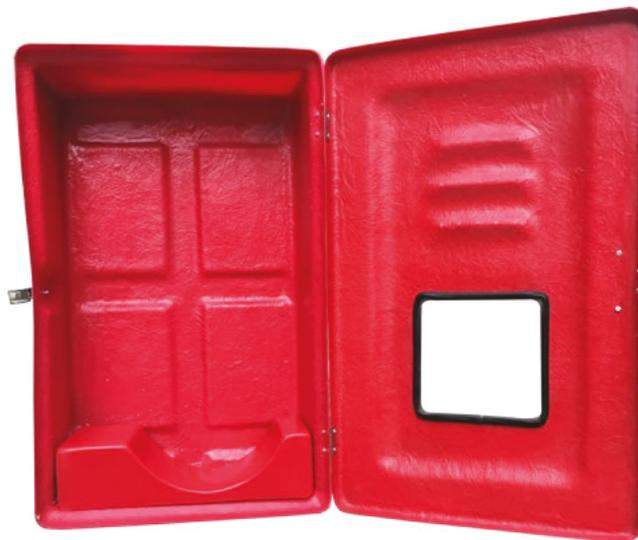
Abrigos para mangueiras, código 741, confeccionados em PRFV (Plástico Reforçado com Fibras de Vidro). Dispensam pintura, pois são pigmentados durante a fabricação com gel coat com aditivo contra raios Uv's. São ideais para ambientes corrosivos e/ou com ação das intempéries. A porta é sobreposta à caixa, prevenindo infiltrações de água, dispensando pingadeiras.
