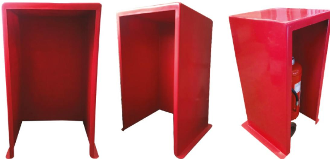
Abrigos para extintor sobre rodas, código 1166, confeccionados em PRFV (Plástico Reforçado com Fibras de Vidro). Dispensam pintura, pois são pigmentados durante a fabricação com gel coat com aditivo contra raios Uv's. São ideais para ambientes corrosivos e/ou com ação das intempéries.
