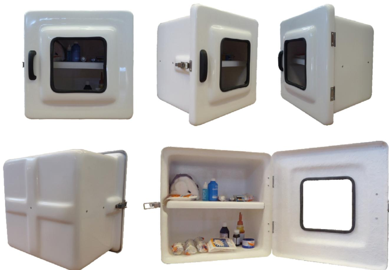
Armários para medicamentos, código 443B, confeccionados em PRFV (Plástico Reforçado com Fibras de Vidro). Dispensam pintura, pois são pigmentados durante a fabricação com gel coat com aditivo contra raios UV's. São ideais para ambientes corrosivos e/ou com ação das intempéries. A porta é sobreposta à caixa, prevenindo infiltrações de água, dispensando pingadeiras.
