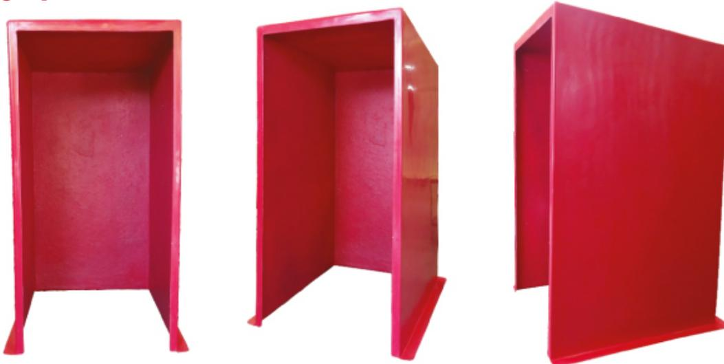
Abrigos para extintor sobre rodas, código 16112, confeccionados em PRFV (Plástico Reforçado com Fibras de Vidro). Dispensam pintura, pois são pigmentados durante a fabricação com gel coat com aditivo contra raios Uv's. São ideais para ambientes corrosivos e/ou com ação das intempéries.
