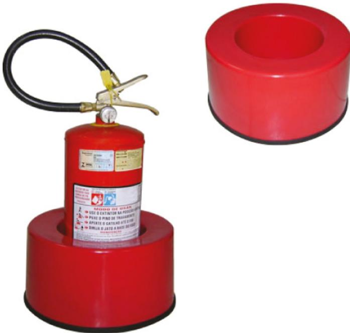
Suportes para extintor, código Circular 18, confeccionados em PRFV (Plástico Reforçado com Fibras de Vidro). Dispensam pintura, pois são pigmentados durante a fabricação com gel coat com aditivo contra raios Uv's. São ideais para ambientes corrosivos e/ou com ação das intempéries.
