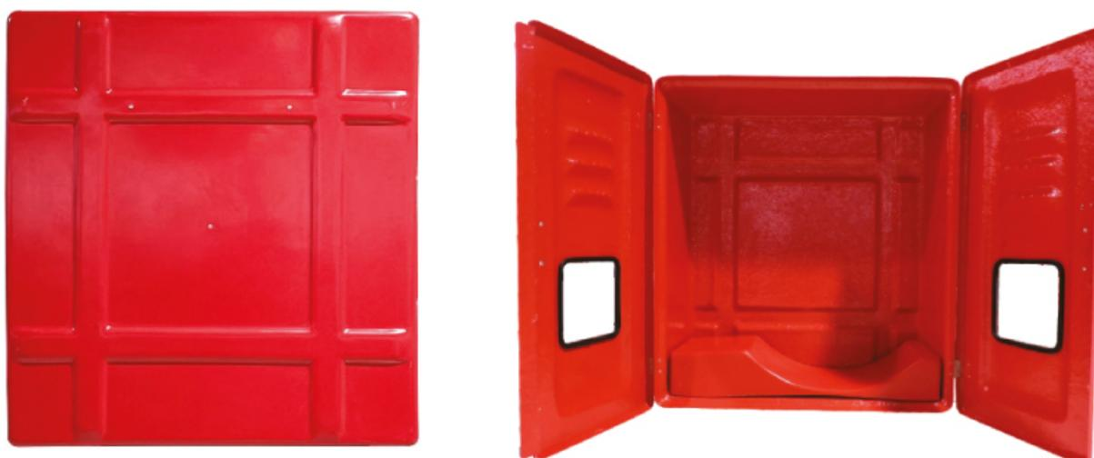
Abrigos para mangueiras, código 983, confeccionados em PRFV (Plástico Reforçado com Fibras de Vidro). Dispensam pintura, pois são pigmentados durante a fabricação com gel coat com aditivo contra raios Uv's. São ideais para ambientes corrosivos e/ou com ação das intempéries. A porta é sobreposta à caixa, prevenindo infiltrações de água, dispensando pingadeiras.
