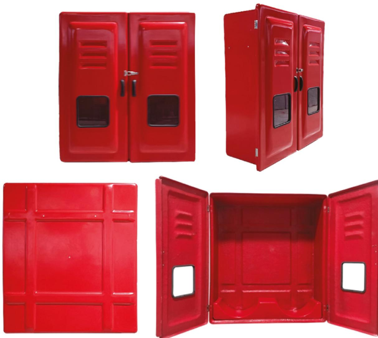
Abrigos para mangueiras, código 1093, confeccionados em PRFV (Plástico Reforçado com Fibras de Vidro). Dispensam pintura, pois são pigmentados durante a fabricação com gel coat com aditivo contra raios Uv's. São ideais para ambientes corrosivos e/ou com ação das intempéries. A porta é sobreposta à caixa, prevenindo infiltrações de água, dispensando pingadeiras.
