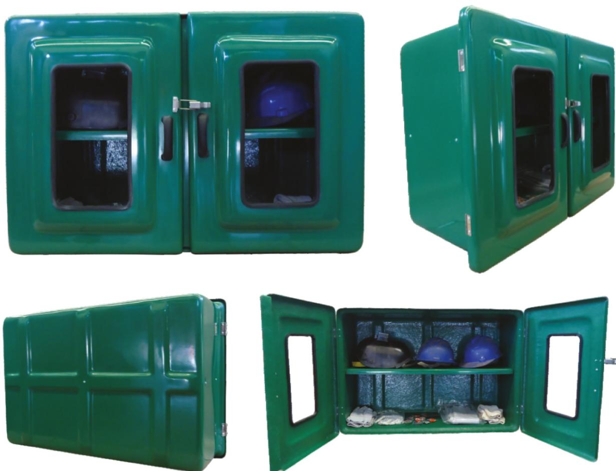
Armários para EPI's, código 693V, confeccionados em PRFV (Plástico Reforçado com Fibras de Vidro). Dispensam pintura, pois são pigmentados durante a fabricação com gel coat com aditivo contra raios UV's. São ideais para ambientes corrosivos e/ou com ação das intempéries. A porta é sobreposta à caixa, prevenindo infiltrações de água, dispensando pingadeiras.
