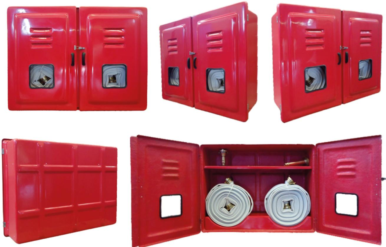
Abrigos para mangueiras, código 9121P, confeccionados em PRFV (Plástico Reforçado com Fibras de Vidro). Dispensam pintura, pois são pigmentados durante a fabricação com gel coat com aditivo contra raios Uv's. São ideais para ambientes corrosivos e/ou com ação das intempéries. A porta é sobreposta à caixa, prevenindo infiltrações de água, dispensando pingadeiras.
