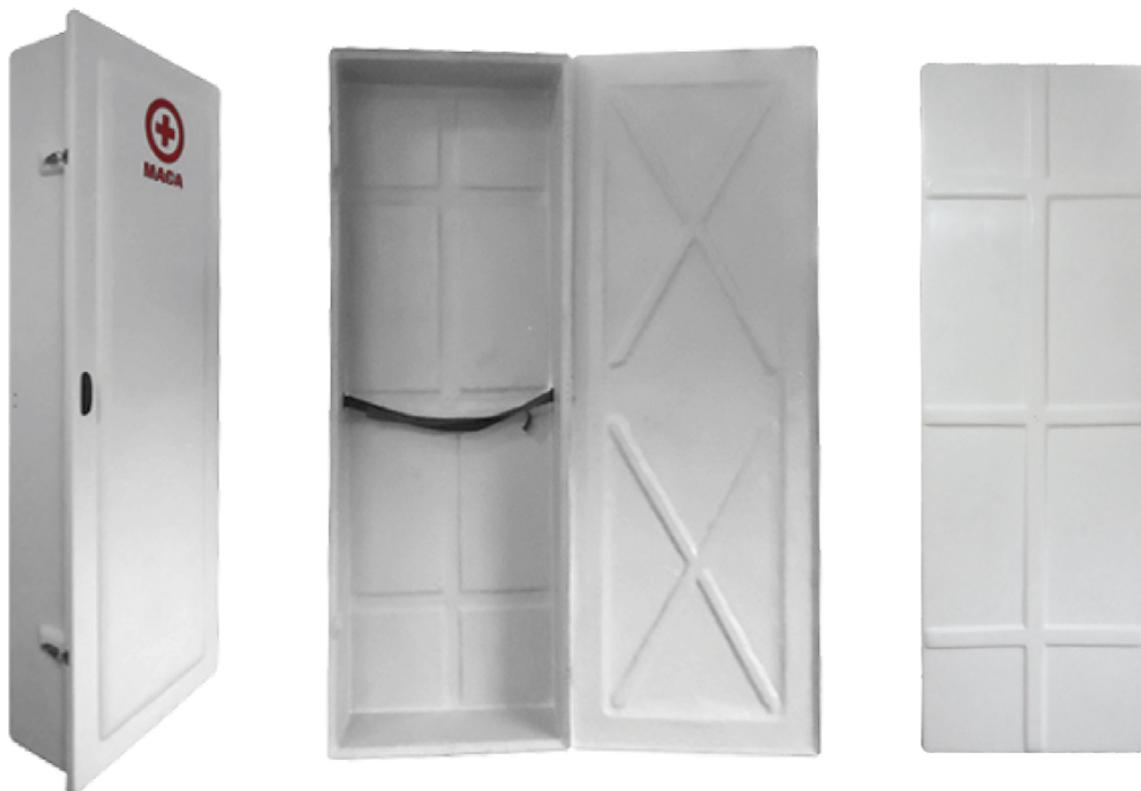
Armários para Maca Rígida, código 2175, confeccionados em PRFV (Plástico Reforçado com Fibras de Vidro). Dispensam pintura, pois são pigmentados durante a fabricação com gel coat com aditivo contra raios Uv's. São ideais para ambientes corrosivos e/ou com ação das intempéries. A porta é sobreposta à caixa, prevenindo infiltrações de água, dispensando pingadeiras.
