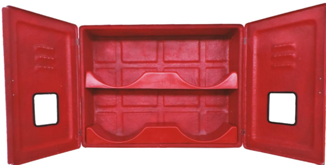
Abrigos para mangueiras, código 9121D, confeccionados em PRFV (Plástico Reforçado com Fibras de Vidro). Dispensam pintura, pois são pigmentados durante a fabricação com gel coat com aditivo contra raios UV's. São ideais para ambientes corrosivos e/ou com ação das intempéries. A porta é sobreposta à caixa, prevenindo infiltrações de água, dispensando pingadeiras.
