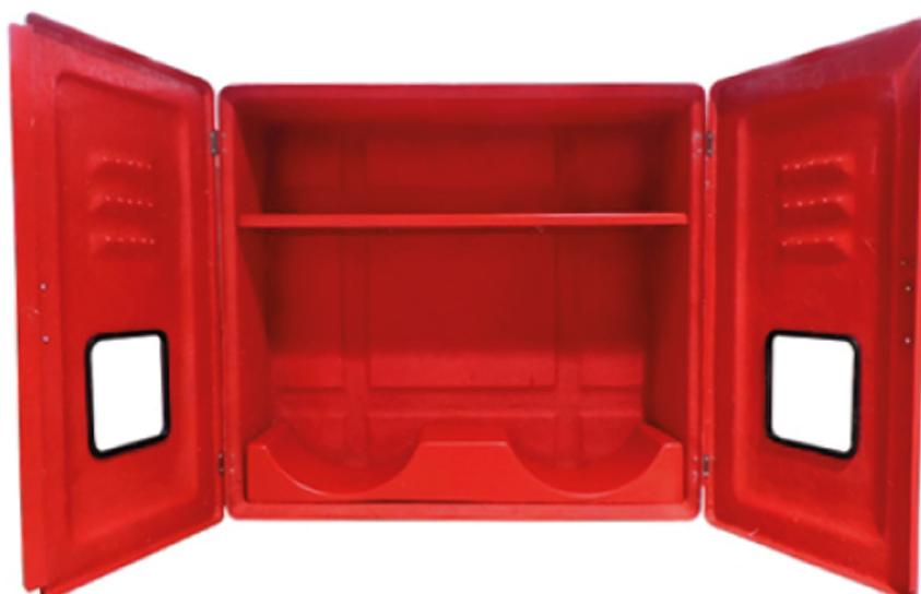
Abrigos para mangueiras, código 9103P, confeccionados em PRFV (Plástico Reforçado com Fibras de Vidro). Dispensam pintura, pois são pigmentados durante a fabricação com gel coat com aditivo contra raios UV's. São ideais para ambientes corrosivos e/ou com ação das intempéries. A porta é sobreposta à caixa, prevenindo infiltrações de água, dispensando pingadeiras.
