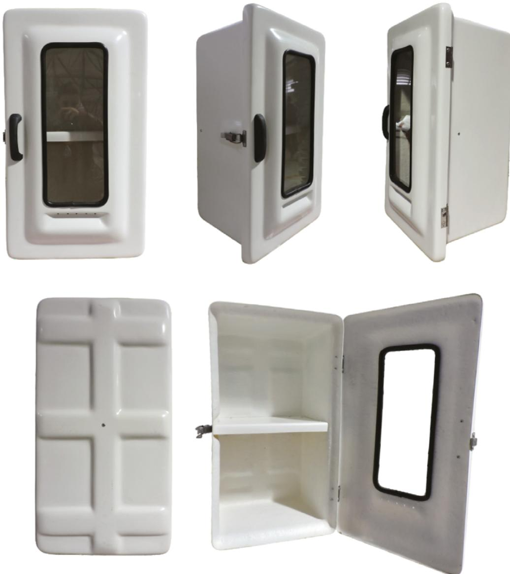
Armários para medicamentos, código 632B, confeccionados em PRFV (Plástico Reforçado com Fibras de Vidro). Dispensam pintura, pois são pigmentados durante a fabricação com gel coat com aditivo contra raios UV's. São ideais para ambientes corrosivos e/ou com ação das intempéries. A porta é sobreposta à caixa, prevenindo infiltrações de água, dispensando pingadeiras.
