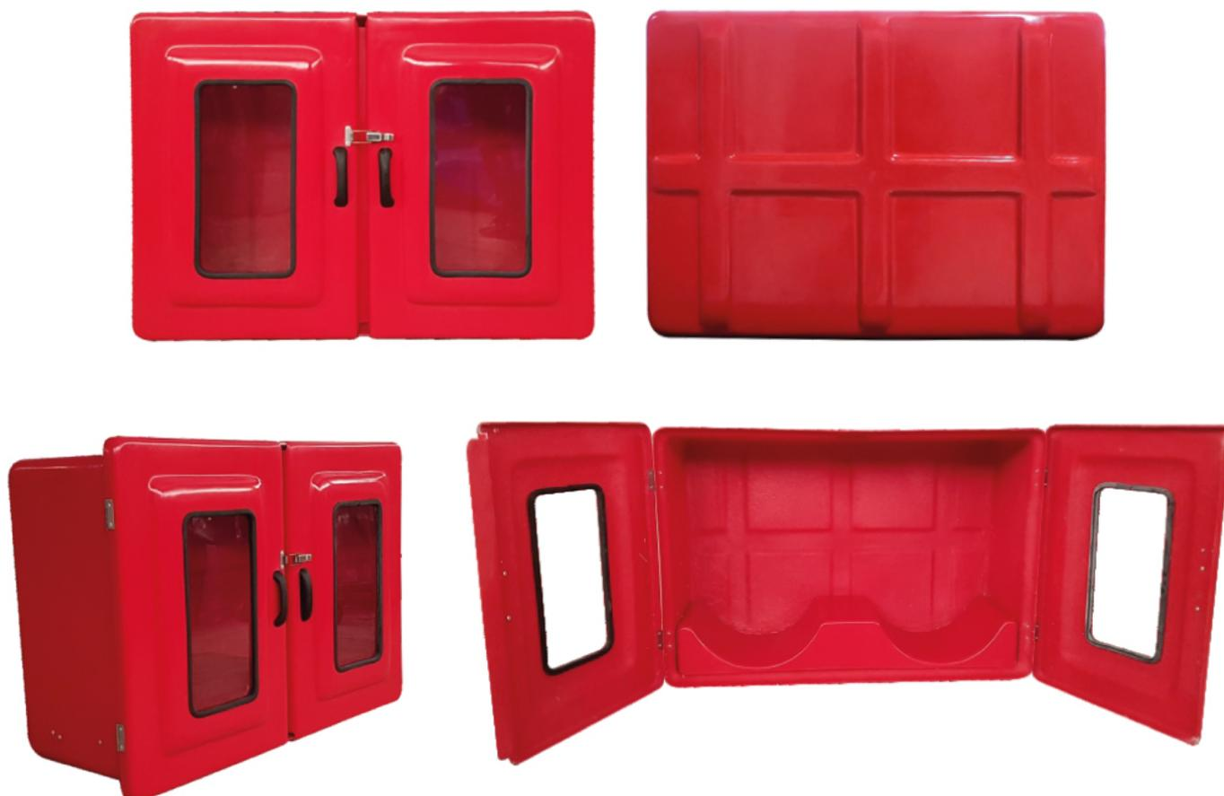
Abrigos para mangueiras, código 693, confeccionados em PRFV (Plástico Reforçado com Fibras de Vidro). Dispensam pintura, pois são pigmentados durante a fabricação com gel coat com aditivo contra raios Uv's. São ideais para ambientes corrosivos e/ou com ação das intempéries. A porta é sobreposta à caixa, prevenindo infiltrações de água, dispensando pingadeiras.
