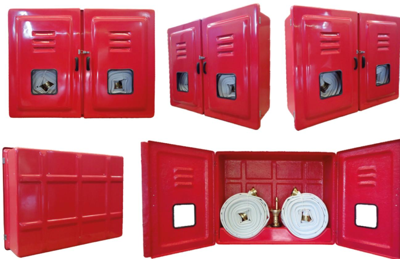
Abrigos para mangueiras, código 9121, confeccionados em PRFV (Plástico Reforçado com Fibras de Vidro). Dispensam pintura, pois são pigmentados durante a fabricação com gel coat com aditivo contra raios UV's. São ideais para ambientes corrosivos e/ou com ação das intempéries. A porta é sobreposta à caixa, prevenindo infiltrações de água, dispensando pingadeiras.
