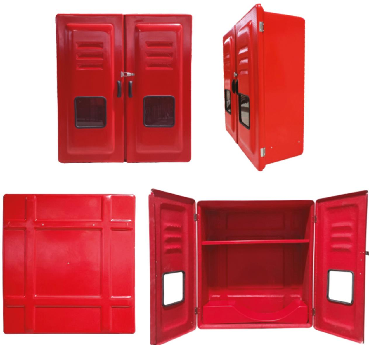
Abrigos para mangueiras, código 983P, confeccionados em PRFV (Plástico Reforçado com Fibras de Vidro). Dispensam pintura, pois são pigmentados durante a fabricação com gel coat com aditivo contra raios Uv's. São ideais para ambientes corrosivos e/ou com ação das intempéries. A porta é sobreposta à caixa, prevenindo infiltrações de água, dispensando pingadeiras.
