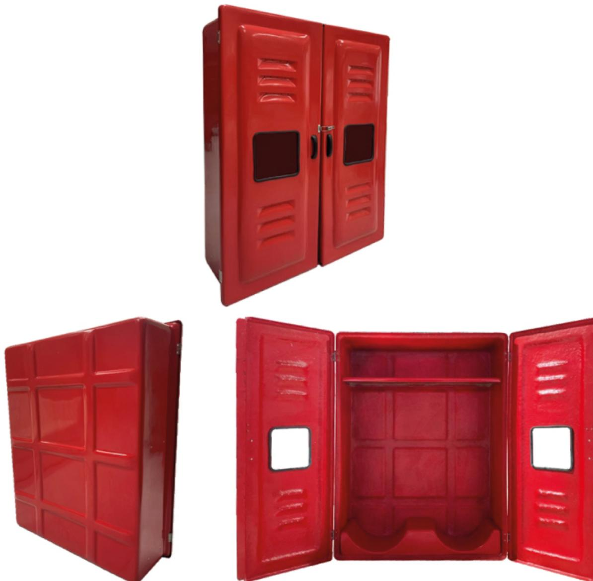
Abrigos para mangueiras, código 1293P confeccionados em PRFV (Plástico Reforçado com Fibras de Vidro). Dispensam pintura, pois são pigmentados durante a fabricação com gel coat com aditivo contra raios UV's. São ideais para ambientes corrosivos e/ou com ação das intempéries. A porta é sobreposta à caixa, prevenindo infiltrações de água, dispensando pingadeiras.
