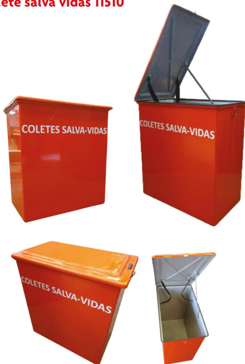
Baú para Coletes Salva Vidas, código 11510, confeccionados em PRFV (Plástico Reforçado com Fibras de Vidro). Dispensam pintura, pois são pigmentados durante a fabricação com gel coat com aditivo contra raios Uv's. São ideais para ambientes corrosivos e/ou com ação das intempéries. A porta é sobreposta à caixa, prevenindo infiltrações de água, dispensando pingadeiras.
