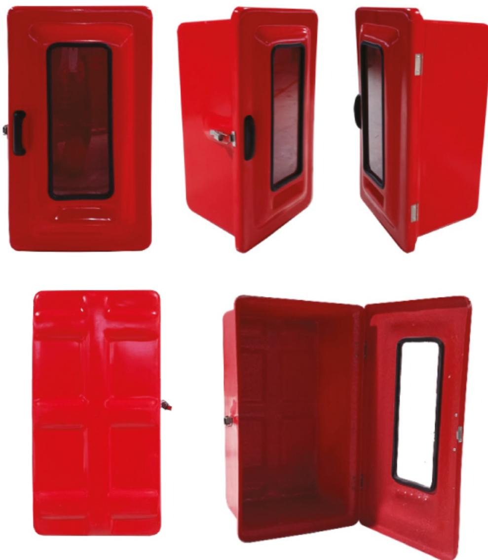
Abrigos para extintor, código 632, confeccionados em PRFV (Plástico Reforçado com Fibras de Vidro). Dispensam pintura, pois são pigmentados durante a fabricação com gel coat com aditivo contra raios Uv's. São ideais para ambientes corrosivos e/ou com ação das intempéries. A porta é sobreposta à caixa, prevenindo infiltrações de água, dispensando pingadeiras.
