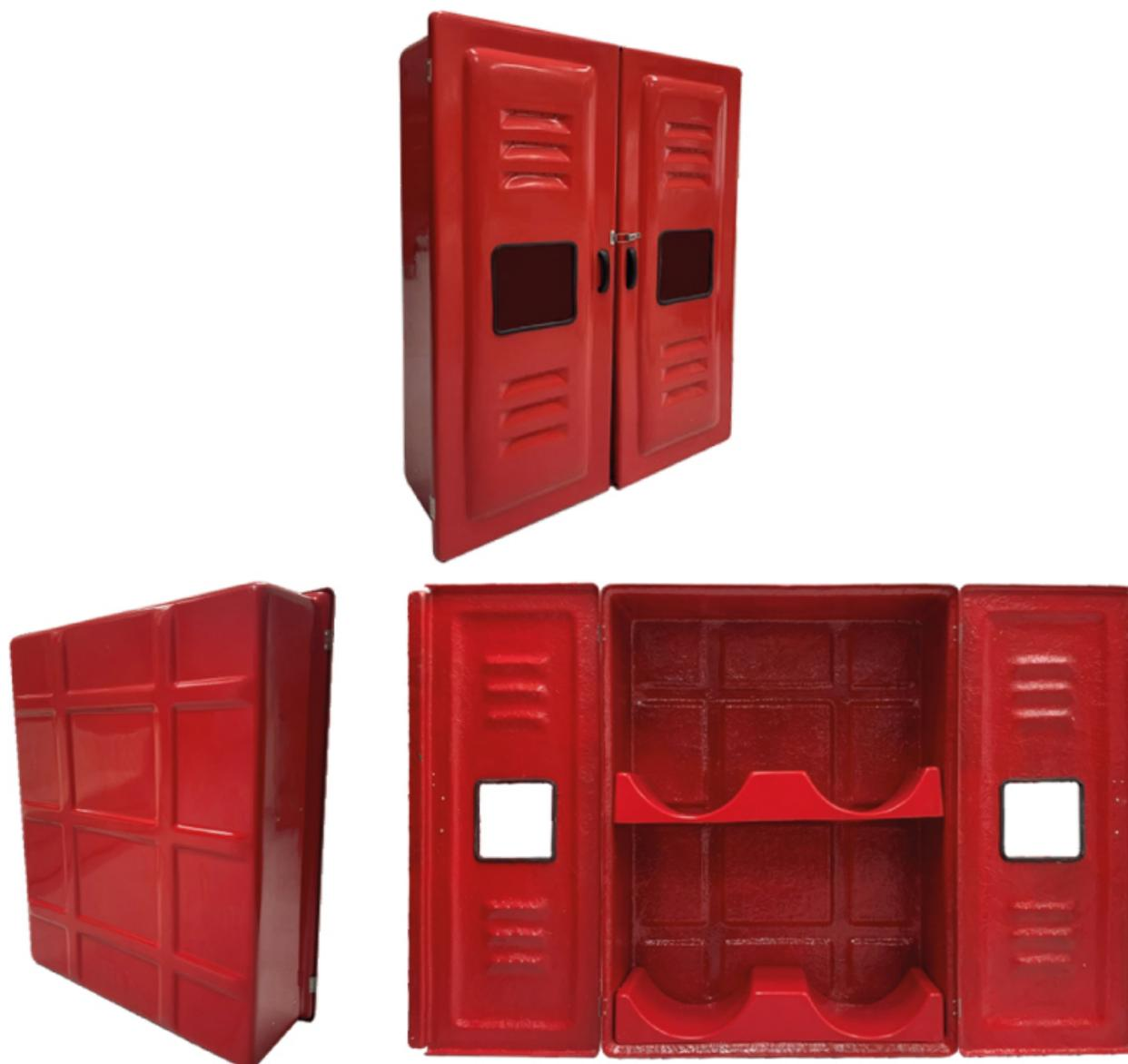
Abrigos para mangueiras, código 1293D confeccionados em PRFV (Plástico Reforçado com Fibras de Vidro). Dispensam pintura, pois são pigmentados durante a fabricação com gel coat com aditivo contra raios UV's. São ideais para ambientes corrosivos e/ou com ação das intempéries. A porta é sobreposta à caixa, prevenindo infiltrações de água, dispensando pingadeiras.
