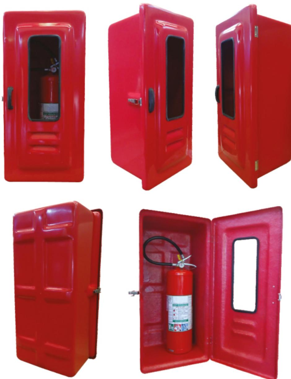
Abrigos para extintor, código 833, confeccionados em PRFV (Plástico Reforçado com Fibras de Vidro). Dispensam pintura, pois são pigmentados durante a fabricação com gel coat com aditivo contra raios Uv's. São ideais para ambientes corrosivos e/ou com ação das intempéries. A porta é sobreposta à caixa, prevenindo infiltrações de água, dispensando pingadeiras.
