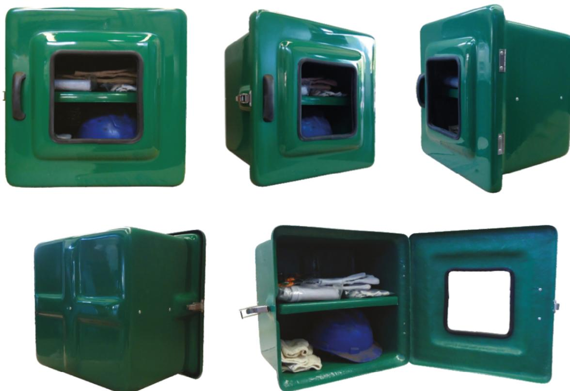
Armários para EPI's, código 443V confeccionados em PRFV (Plástico Reforçado com Fibras de Vidro). Dispensam pintura, pois são pigmentados durante a fabricação com gel coat com aditivo contra raios Uv's. São ideais para ambientes corrosivos e/ou com ação das intempéries. A porta é sobreposta à caixa, prevenindo infiltrações de água, dispensando pingadeiras.
