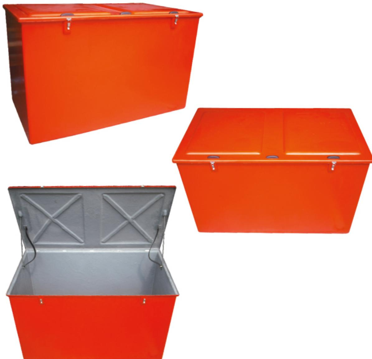
Baú para Coletes Salva Vidas, código 11810, confeccionados em PRFV (Plástico Reforçado com Fibras de Vidro). Dispensam pintura, pois são pigmentados durante a fabricação com gel coat com aditivo contra raios Uv's. São ideais para ambientes corrosivos e/ou com ação das intempéries. A porta é sobreposta à caixa, prevenindo infiltrações de água, dispensando pingadeiras.
