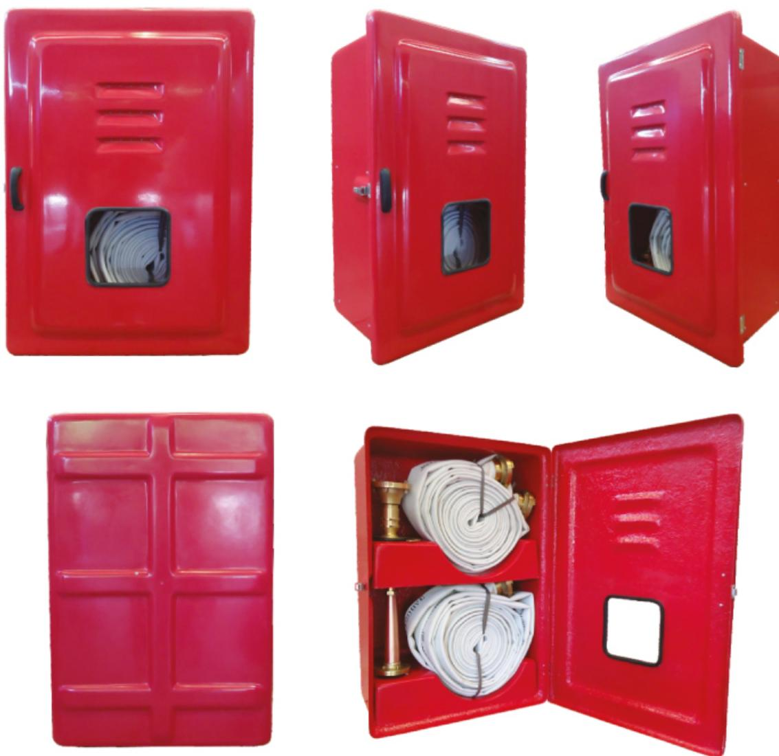
Abrigos para mangueiras, código 963D, confeccionados em PRFV (Plástico Reforçado com Fibras de Vidro). Dispensam pintura, pois são pigmentados durante a fabricação com gel coat com aditivo contra raios UV's. São ideais para ambientes corrosivos e/ou com ação das intempéries. A porta é sobreposta à caixa, prevenindo infiltrações de água, dispensando pingadeiras.
