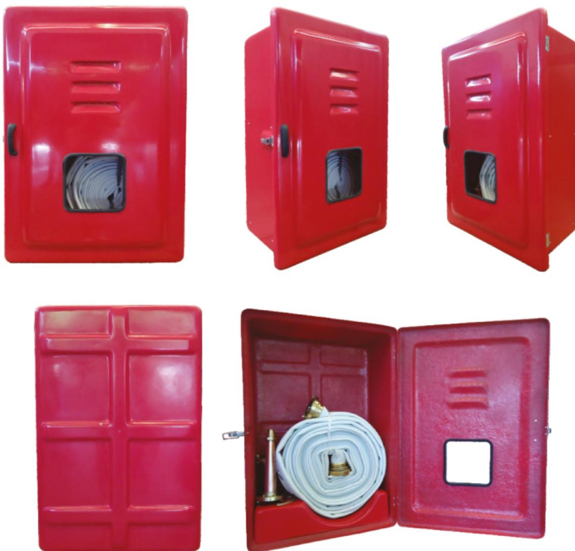
Abrigos para mangueiras, código 963, confeccionados em PRFV (Plástico Reforçado com Fibras de Vidro). Dispensam pintura, pois são pigmentados durante a fabricação com gel coat com aditivo contra raios UV's. São ideais para ambientes corrosivos e/ou com ação das intempéries. A porta é sobreposta à caixa, prevenindo infiltrações de água, dispensando pingadeiras.
