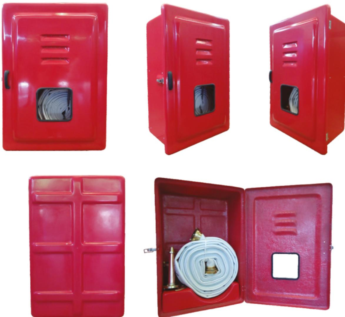
Abrigos para mangueiras, código 961, confeccionados em PRFV (Plástico Reforçado com Fibras de Vidro). Dispensam pintura, pois são pigmentados durante a fabricação com gel coat com aditivo contra raios UV's. São ideais para ambientes corrosivos e/ou com ação das intempéries. A porta é sobreposta à caixa, prevenindo infiltrações de água, dispensando pingadeiras.
