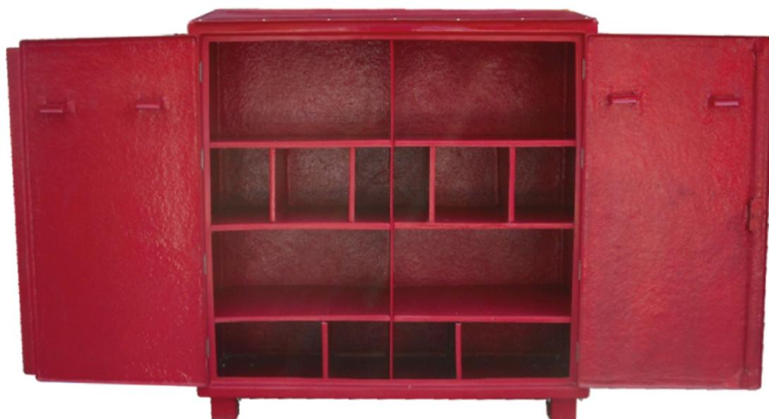
Armários para uso geral / equipamentos, código A4 confeccionados em PRFV (Plástico Reforçado com Fibras de Vidro). Dispensam pintura, pois são pigmentados durante a fabricação com gel coat com aditivo contra raios Uv's. São ideais para ambientes corrosivos e/ou com ação das intempéries.
