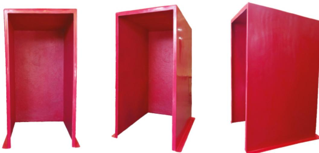
Abrigos para extintor sobre rodas, código 1579, confeccionados em PRFV (Plástico Reforçado com Fibras de Vidro). Dispensam pintura, pois são pigmentados durante a fabricação com gel coat com aditivo contra raios Uv's. São ideais para ambientes corrosivos e/ou com ação das intempéries.
