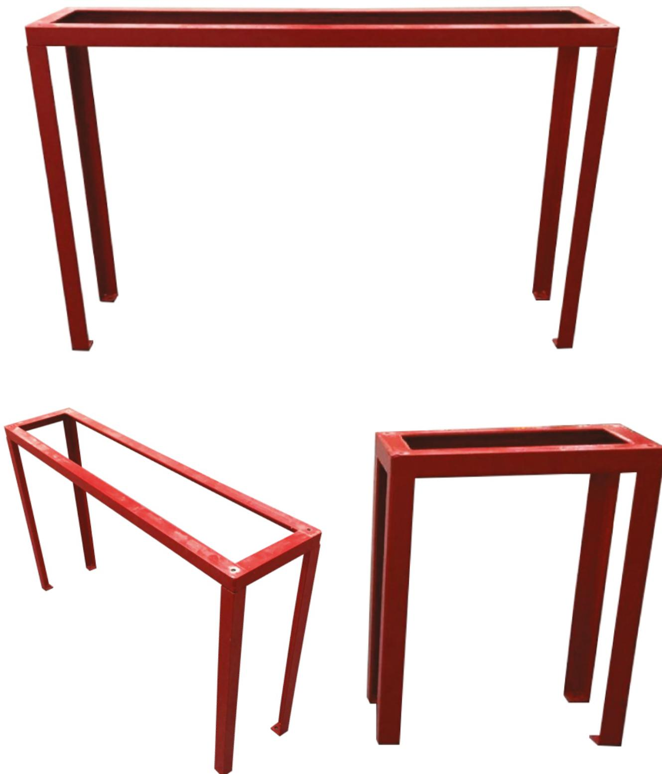
Pedestais confeccionados em perfil «L», com medidas de 1 1/2" x 3/16", eletrosoldadas e com pintura eletrostática a pó, na cor vermelho texturizada.
