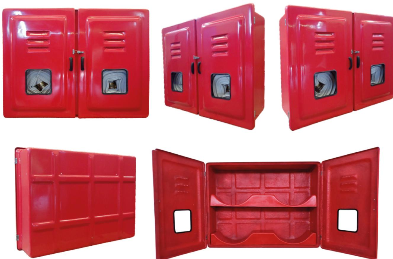
Abrigos para mangueiras, código 9123D, confeccionados em PRFV (Plástico Reforçado com Fibras de Vidro). Dispensam pintura, pois são pigmentados durante a fabricação com gel coat com aditivo contra raios Uv's. São ideais para ambientes corrosivos e/ou com ação das intempéries. A porta é sobreposta à caixa, prevenindo infiltrações de água, dispensando pingadeiras.
