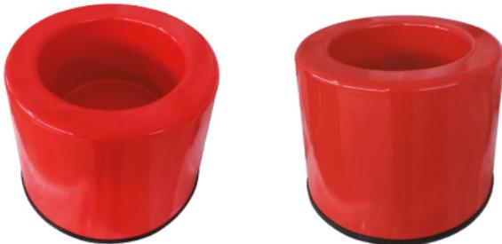
Suportes para extintor, código Circular 25, confeccionados em PRFV (Plástico Reforçado com Fibras de Vidro). Dispensam pintura, pois são pigmentados durante a fabricação com gel coat com aditivo contra raios UV's. São ideais para ambientes corrosivos e/ou com ação das intempéries.
