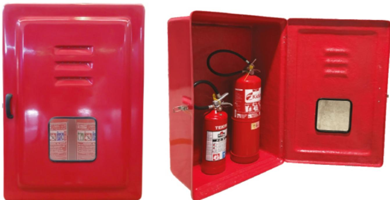
Abrigos duplos para extintores, código 963E, confeccionados em PRFV (Plástico Reforçado com Fibras de Vidro). Dispensam pintura, pois são pigmentados durante a fabricação com gel coat com aditivo contra raios UV's. São ideais para ambientes corrosivos e/ou com ação das intempéries. A porta é sobreposta à caixa, prevenindo infiltrações de água, dispensando pingadeiras.
