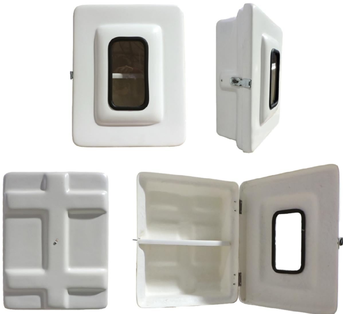
Armários para medicamentos, código 431B, confeccionados em PRFV (Plástico Reforçado com Fibras de Vidro). Dispensam pintura, pois são pigmentados durante a fabricação com gel coat com aditivo contra raios Uv's. São ideais para ambientes corrosivos e/ou com ação das intempéries. A porta é sobreposta à caixa, prevenindo infiltrações de água, dispensando pingadeiras.
