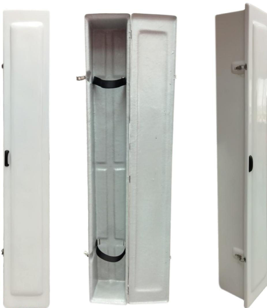
Armários para Maca código 212525, confeccionados em PRFV (Plástico Reforçado com Fibras de Vidro). Dispensam pintura, pois são pigmentados durante a fabricação com gel coat com aditivo contra raios Uv's. São ideais para ambientes corrosivos e/ou com ação das intempéries. A porta é sobreposta à caixa, prevenindo infiltrações de água, dispensando pingadeiras.
