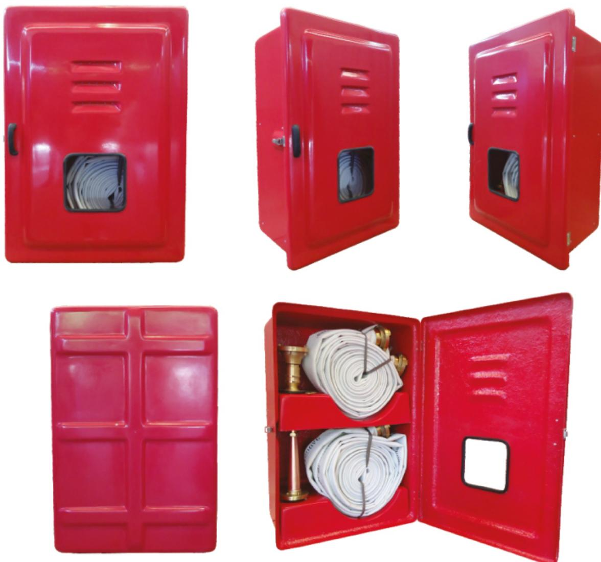
Abrigos para mangueiras, código 961D, confeccionados em PRFV (Plástico Reforçado com Fibras de Vidro). Dispensam pintura, pois são pigmentados durante a fabricação com gel coat com aditivo contra raios UV's. São ideais para ambientes corrosivos e/ou com ação das intempéries. A porta é sobreposta à caixa, prevenindo infiltrações de água, dispensando pingadeiras.
