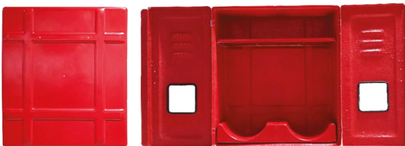
Abrigos para mangueiras, código 1093P, confeccionados em PRFV (Plástico Reforçado com Fibras de Vidro). Dispensam pintura, pois são pigmentados durante a fabricação com gel coat com aditivo contra raios UV's. São ideais para ambientes corrosivos e/ou com ação das intempéries. A porta é sobreposta à caixa, prevenindo infiltrações de água, dispensando pingadeiras.
