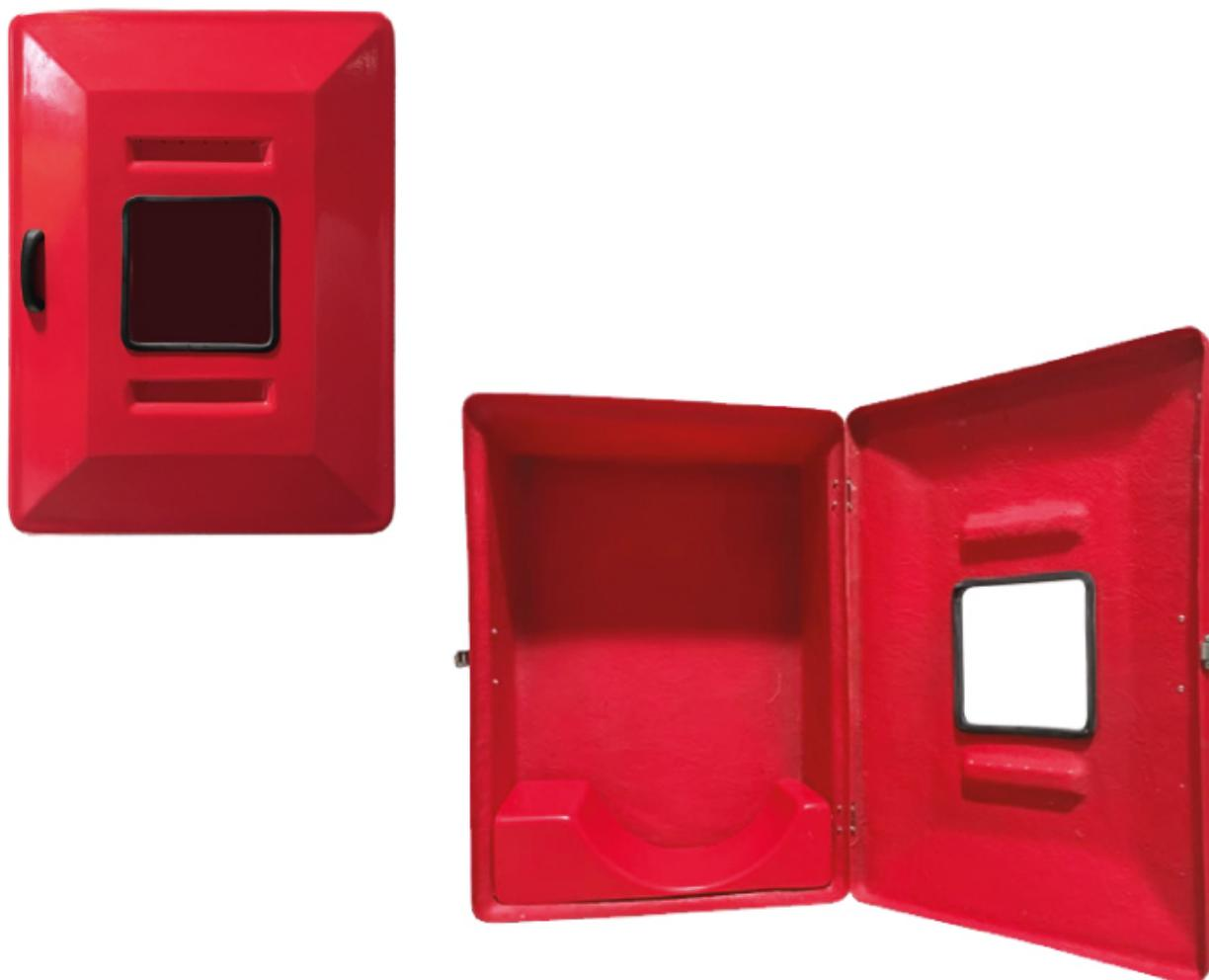
Abrigos para mangueiras, código 752, confeccionados em PRFV (Plástico Reforçado com Fibras de Vidro). Dispensam pintura, pois são pigmentados durante a fabricação com gel coat com aditivo contra raios UV's. São ideais para ambientes corrosivos e/ou com ação das intempéries. A porta é sobreposta à caixa, prevenindo infiltrações de água, dispensando pingadeiras.
