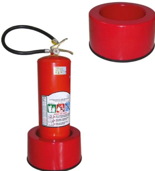
Suportes para extintor, código Circular 20, confeccionados em PRFV (Plástico Reforçado com Fibras de Vidro). Dispensam pintura, pois são pigmentados durante a fabricação com gel coat com aditivo contra raios Uv's. São ideais para ambientes corrosivos e/ou com ação das intempéries.
