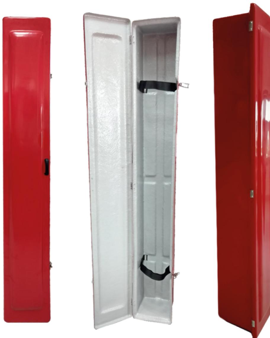
Armários para Manta antichamas, código 212525 manta, confeccionados em PRFV (Plástico Reforçado com Fibras de Vidro). Dispensam pintura, pois são pigmentados durante a fabricação com gel coat com aditivo contra raios UV's. São ideais para ambientes corrosivos e/ou com ação das intempéries. A porta é sobreposta à caixa, prevenindo infiltrações de água, dispensando pingadeiras.
