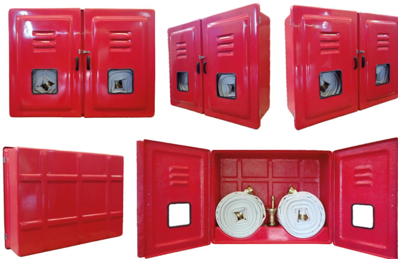
Abrigos para mangueiras, código 9123, confeccionados em PRFV (Plástico Reforçado com Fibras de Vidro). Dispensam pintura, pois são pigmentados durante a fabricação com gel coat com aditivo contra raios Uv's. São ideais para ambientes corrosivos e/ou com ação das intempéries. A porta é sobreposta à caixa, prevenindo infiltrações de água, dispensando pingadeiras.
