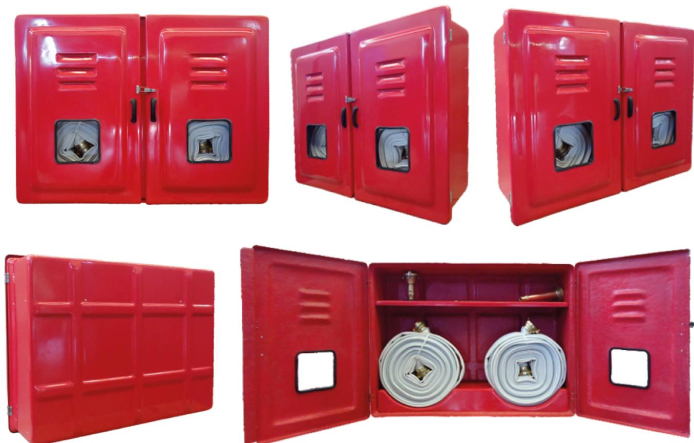
Abrigos para mangueiras, código 9123P, confeccionados em PRFV (Plástico Reforçado com Fibras de Vidro). Dispensam pintura, pois são pigmentados durante a fabricação com gel coat com aditivo contra raios Uv's. São ideais para ambientes corrosivos e/ou com ação das intempéries. A porta é sobreposta à caixa, prevenindo infiltrações de água, dispensando pingadeiras.
