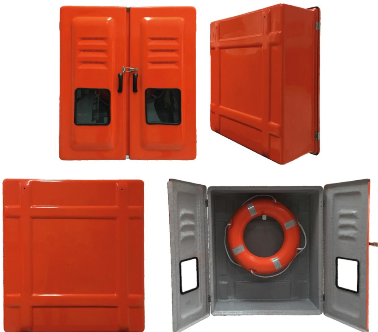
Abrigos para Boias salva-vidas, código 983 Boia, confeccionados em PRFV (Plástico Reforçado com Fibras de Vidro). Dispensam pintura, pois são pigmentados durante a fabricação com gel coat com aditivo contra raios Uv's. São ideais para ambientes corrosivos e/ou com ação das intempéries. A porta é sobreposta à caixa, prevenindo infiltrações de água, dispensando pingadeiras.
