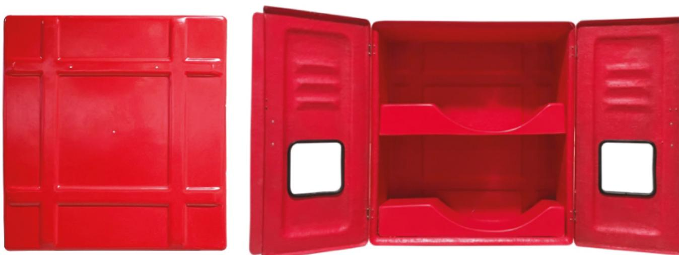
Abrigos para mangueiras, código 983D, confeccionados em PRFV (Plástico Reforçado com Fibras de Vidro). Dispensam pintura, pois são pigmentados durante a fabricação com gel coat com aditivo contra raios Uv's. São ideais para ambientes corrosivos e/ou com ação das intempéries. A porta é sobreposta à caixa, prevenindo infiltrações de água, dispensando pingadeiras.
